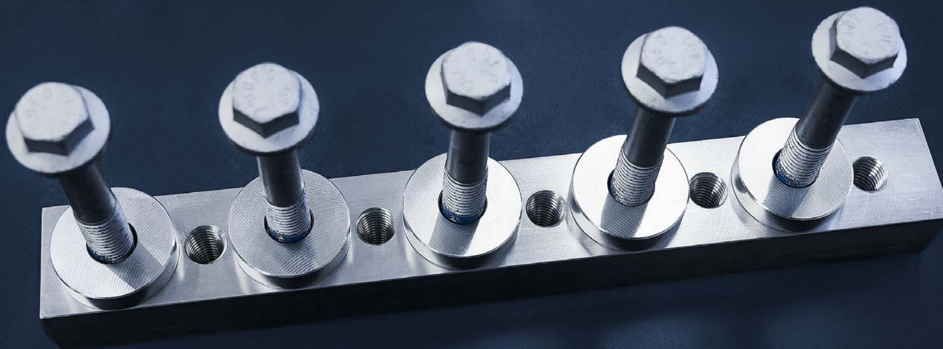
Testmaterial och uppställning för friktionsprovning.
